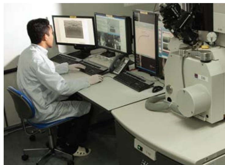
Sistem Dual Beam, salah satu peralatan yang disediakan di fasiliti berkongsi analisis kegagalan MIMOS
