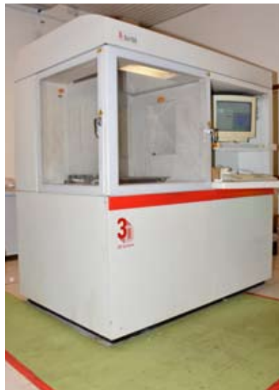
SLA 7000: Mesin ini menghasilkan komponen yang digunakan untuk selitan dai dan acuan, jigs dan kelengkapan. Komponen ini adalah sesuai untuk keadaan persekitaran yang bersuhu tinggi
